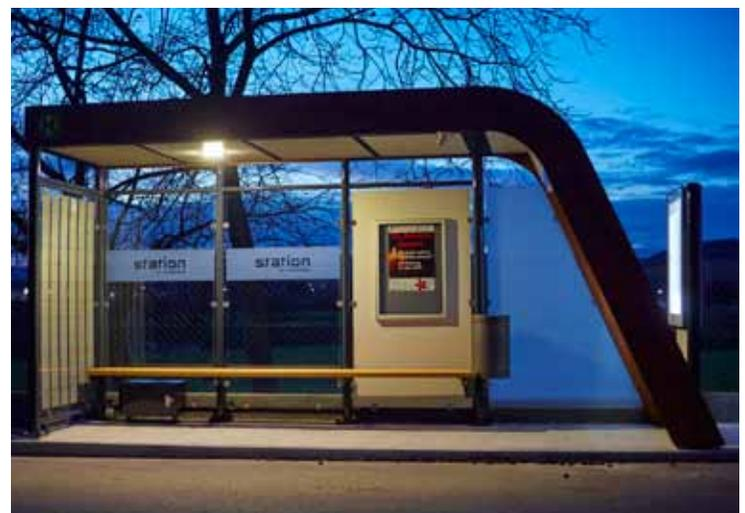
Beleuchtung ohne Stromanschluss: Ein Solarpanel liefert die Energie für den unter der Bank angebrachten Akku.
